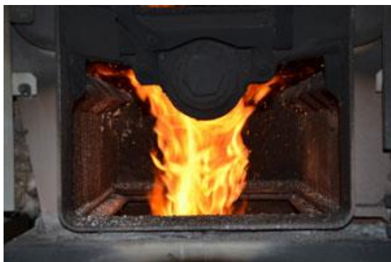
Obr. č. 13 Optimální tvar plamene
